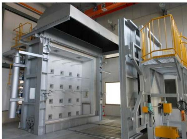
写真-3 大型壁炉 1
