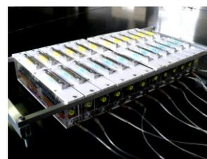
写真 2 多点風圧計(354ch)
