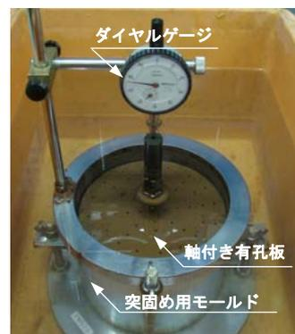
写真1 吸水膨張試験
