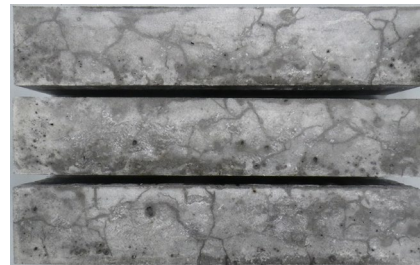
写真2 JASS 5N T-603において「反応性あり」と判定されたコンクリートバーの表面状況の例
