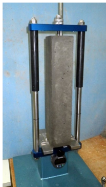
写真1 コンクリートバーの長さ変化測定状況
