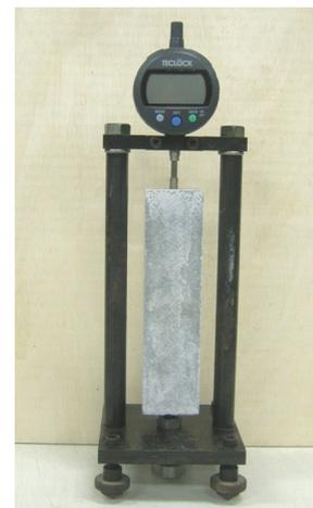
写真1 モルタルバーの長さ変化測定状況
