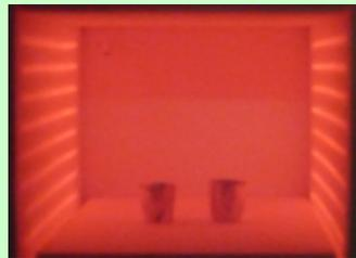
1000±50°Cの電気炉で強熱し、強熱後の質量から骨材量を算出します。
