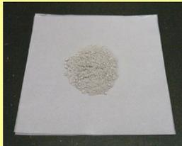
コアは、単位容積質量および吸水率を測定した後、所定の粒度まで粉碎し、分析試料を採取します。
