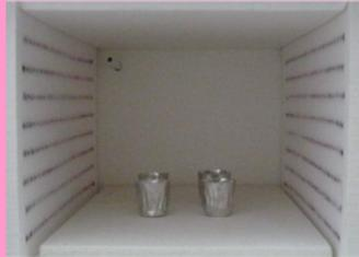
600±50°Cの電気炉で強熱し、質量の減少量から結合水量を算出します。
