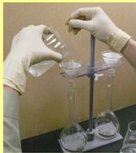
溶解した試料をろ過し、残留物から骨材量を、ろ液からセメント量を推定します。
