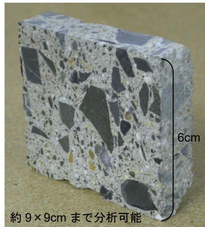
ダイヤモンドカッターで切断し、平板状の試料に成型します。切断時には、目的に応じて、乾式・湿式を使い分けます。また、脆弱層がある場合などには、試料を樹脂に包埋して補強した後、切断作業を行います。樹脂の硬化には、数日を要します。
