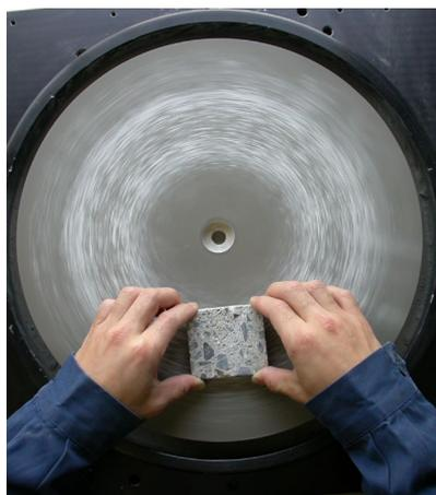
分析面を研磨し、平滑にします。必要に応じ、研磨面に樹脂を含浸させて補強します。研磨盤の目を徐々に細かくし、鏡面状に仕上げます。
