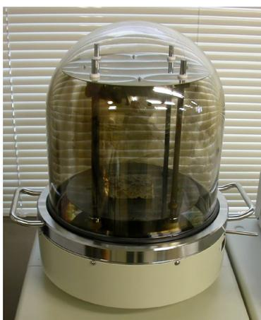
試料を真空乾燥させた後に、分析面にカーボンまたは金を蒸着させます。真空乾燥は十分に行う必要があり、数日を要します。
