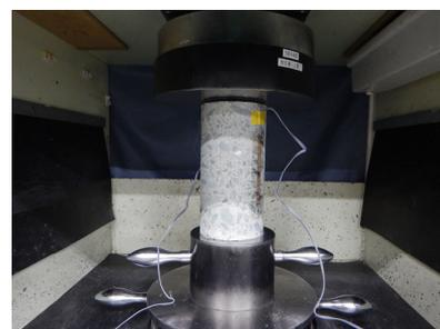
ひずみゲージでの測定状況
