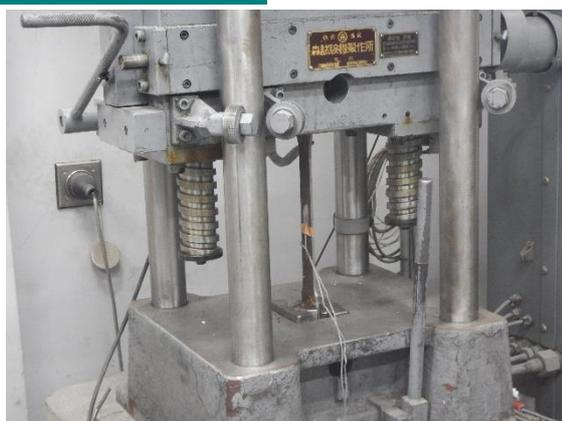
目視観察において火災の影響を受けていると判断される構造部材から鋼材のサンプルを採取し、JIS Z 2241 等に基づき引張試験を行います。火災の影響を受けていない箇所から採取したサンプルの試験結果や、鋼材の当初の機械的性質と比較することで、火害等級の判断や補修、補強の可否の判断に用います。
