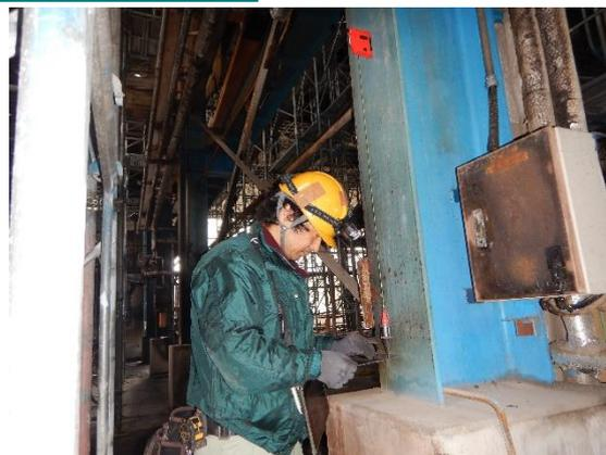
柱の倒れや梁のたわみを測定し、(一社)日本建築学会「建築物の火害診断および補修・補強方法 指針・同解説」に記載の許容変形量と比較し、火害等級の判断に用います。柱については、下げ振りと金尺を用いて倒れ量とその方向を確認します。梁については、レベル測定器や水系、金尺などを用いてたわみ量を測定します。
