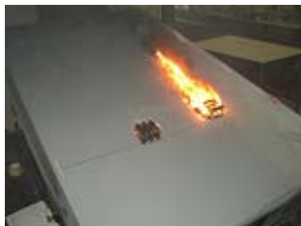
屋根葺き材の燃焼状況
