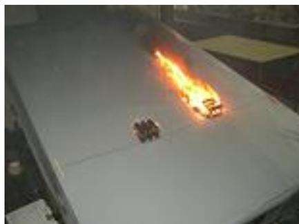
屋根葺き材の燃焼状況
