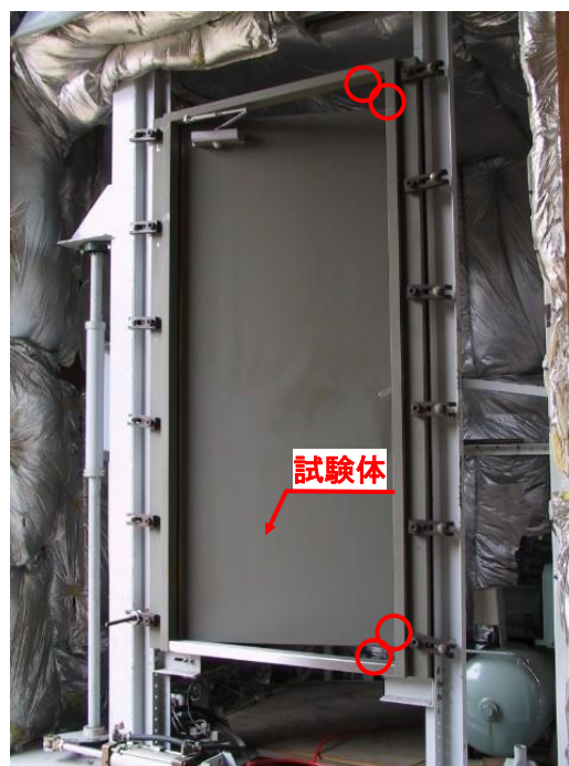
○ : 戸と枠の隙間を測定
