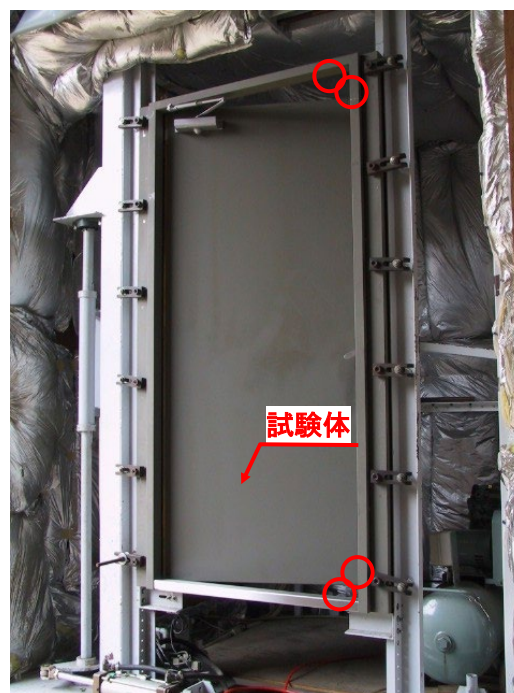
○ : 戸と枠の隙間を測定
