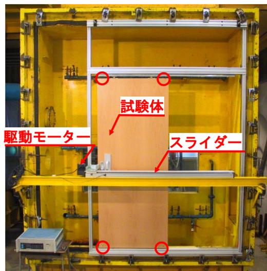
○：戸と枠の隙間を測定
