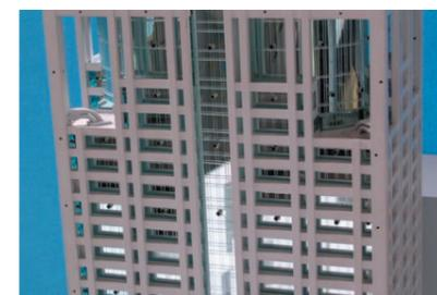
壁面の小さな穴が風圧測定点
