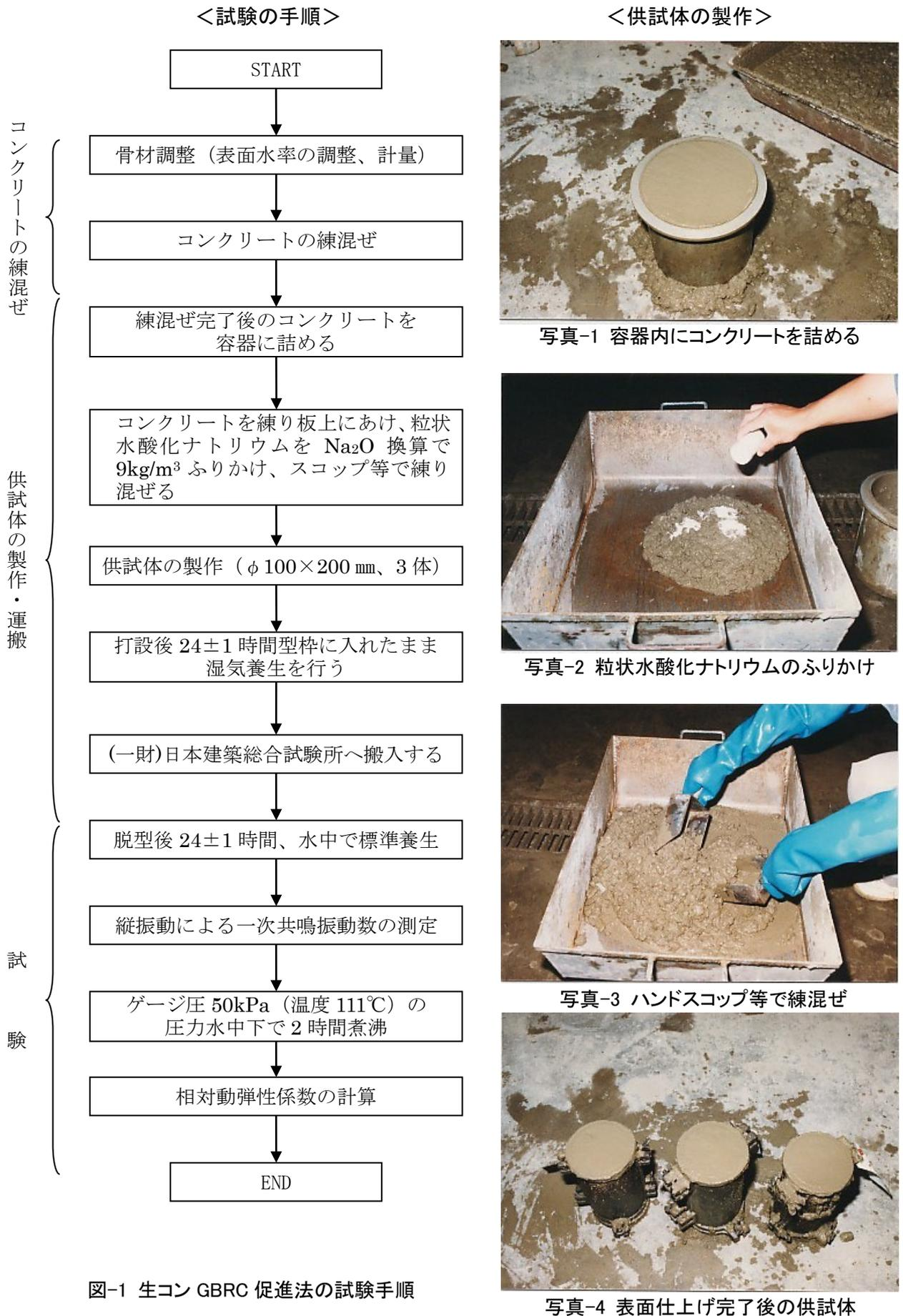
図-1 生コン GBRC 促進法の試験手順
