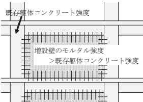
図-1 鉄筋モルタル増設壁の構成
