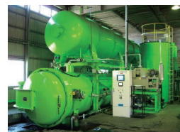
写真-4 加圧注入木材保存処理
