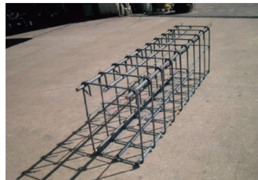
写真-2 現場組み立て 鉄筋スポット先組工法ユニット
