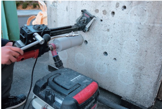
写真-1 乾式コアの採取状況
