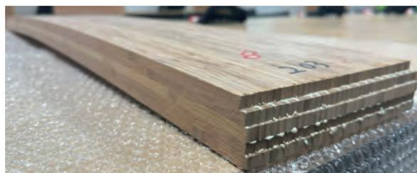
写真-5 1方向湾曲竹集成材製作過程
