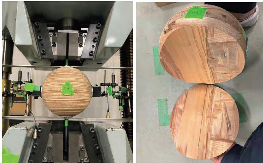
写真-3 紙管ドームの木接合部実験 (左: 極厚合板 (不採用)、右: CLT (採用))
