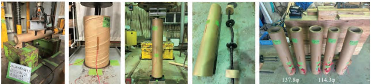
写真-2 紙管ドームの部材実験 (左から紙管曲げ実験・圧縮実験・部材圧縮実験)
