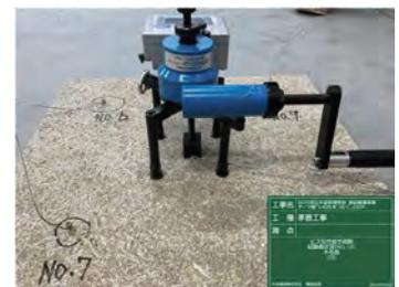
写真-7 茅留付けビス試験の様子
