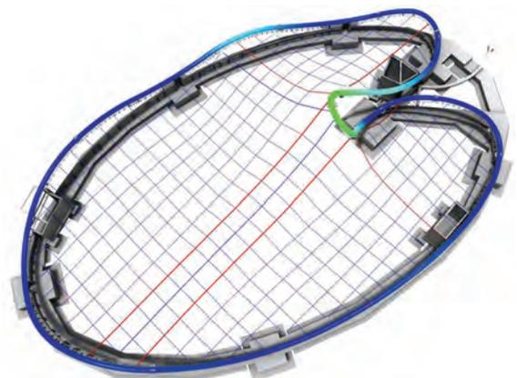
図-20 ケーブル架設時変位イメージ (BIM)
