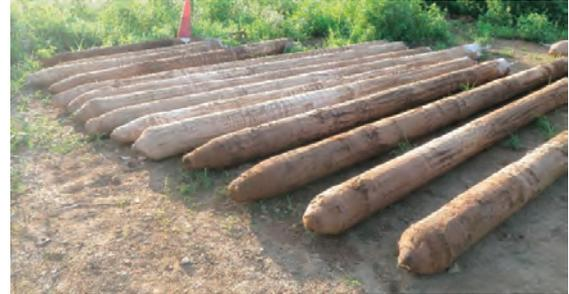
図-1 引き抜いた柱体の状況
