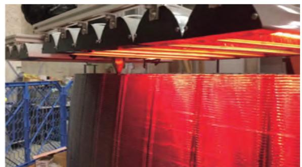
写真-7 ハロゲンヒーターによる予熱
