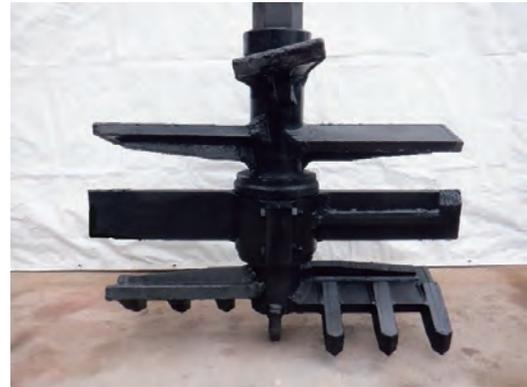
写真-1 掘削攪拌ヘッドの例 (φ1000)
