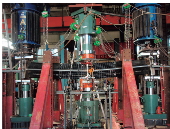
a) 柱としての性能確認 (3点曲げ試験)
