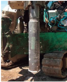
写真-2 芯部築造用先端ビット
