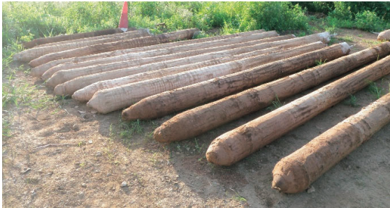
図-1 引き抜いた柱体の状況
