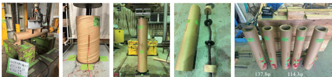
写真-2 紙管ドームの部材実験 (左から紙管曲げ実験・圧縮実験・部材圧縮実験)
