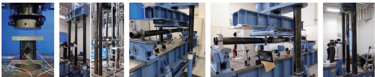
写真-4 CFRPドームの部材実験および接合部実験
