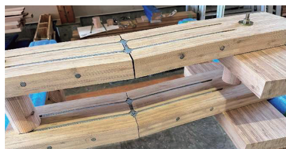
写真-9 接合部モックアップ
