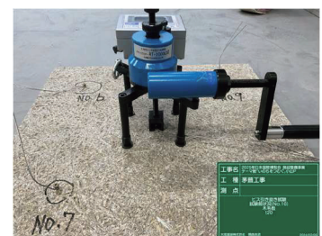
写真-7 茅留付けビス試験の様子
