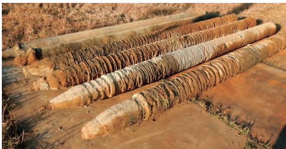
図-1 引き抜いた柱体の状況
