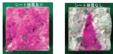
写真-1 中性化促進試験結果
