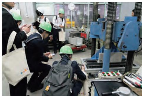
写真-15 プレキャストコンクリート製品の曲げ試験実演
