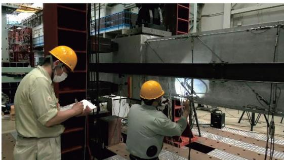
【鉄筋コンクリート梁の実験状況】
