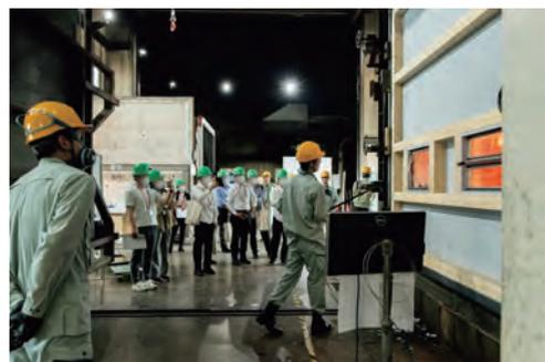
写真-19 耐熱結晶化ガラスおよび複層ガラスを用いて防火設備を模擬した加熱試験実演
