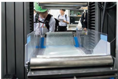
写真-11 強化ガラスの曲げ試験実演
