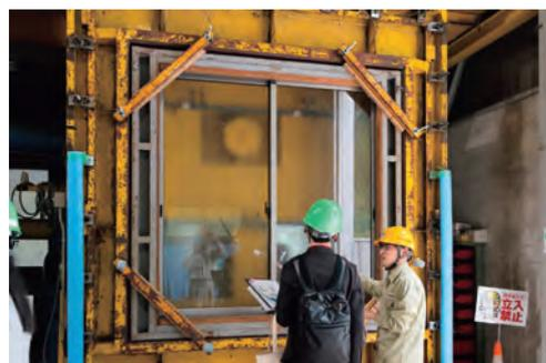
写真-13 サッシの水密試験実演
