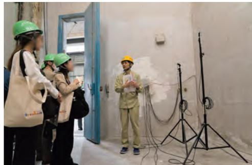
写真-8 残響室での界壁の音響透過損失試験実演
