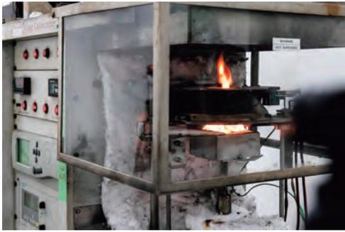
写真-21 発熱性試験装置 (CCM) を用いた性能比較試験実演
