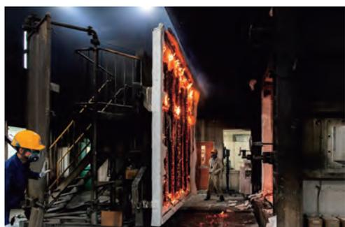
写真-20 防火構造外壁を模擬した加熱試験実演
