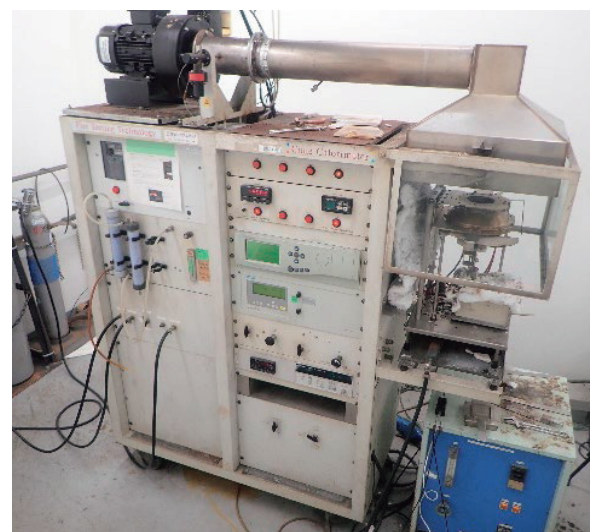
写真-2 コーンカロリメータ (Part 10対応)
