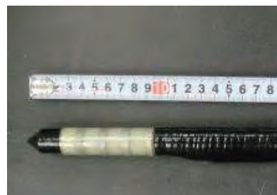
写真-2 比抵抗測定装置 (ミキシングテスター)
