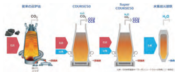
図-11 鉄鉱石の還元装置と使用水素量の違い 9)
