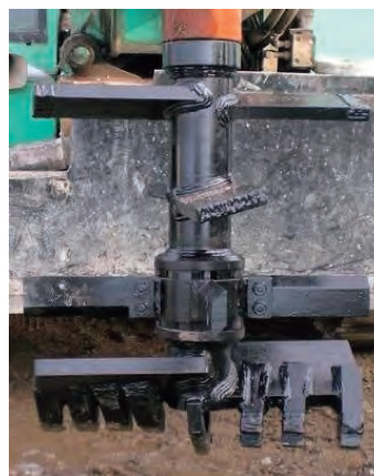
写真-1 掘削ヘッド
