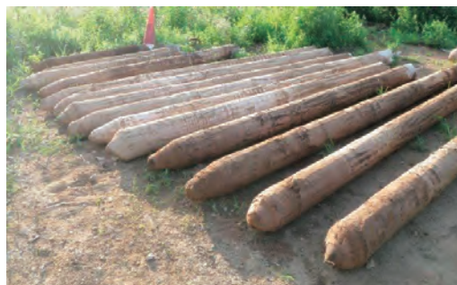
図-1 引き抜いた柱体の状況
