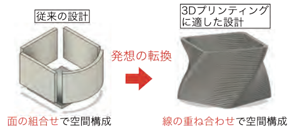
図-19 3Dプリンティングに適した設計
