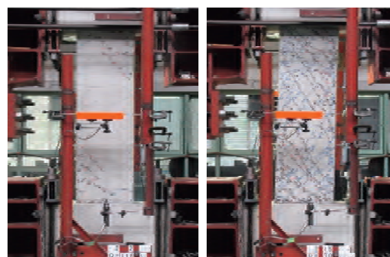
写真-1 RC造梁部材のひび割れ状況
