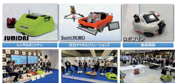
写真-7 3体の墨出しロボットとイベント実施風景
