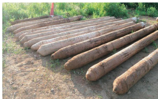
図-1 引き抜いた柱体の状況
