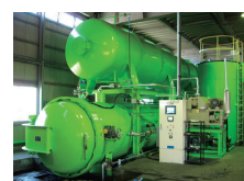
写真-4 加圧注入木材保存処理
