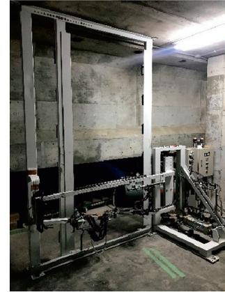
写真-10 開閉繰返し試験装置
