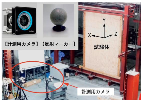
写真-5 画像処理計測システム
