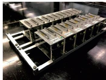
写真-6 多点圧力同時計測システム
