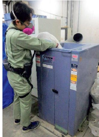
写真-10 大型多段振とう機
