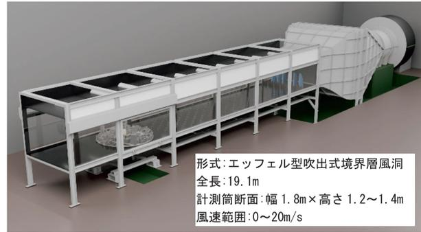
図-5 風洞装置の外観
