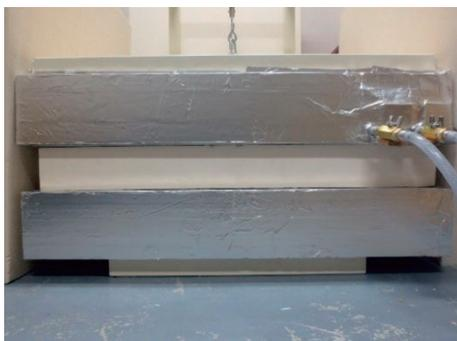
写真-4 大型熱伝導率試験装置
