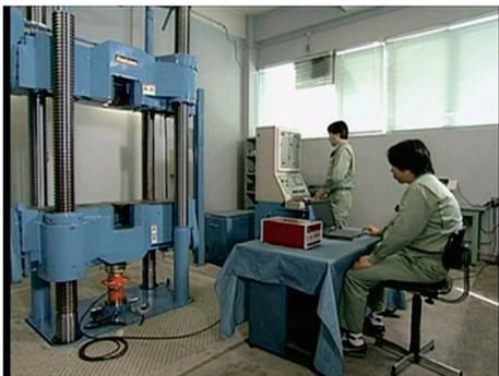
写真-1 校正状況 (一軸試験機)
