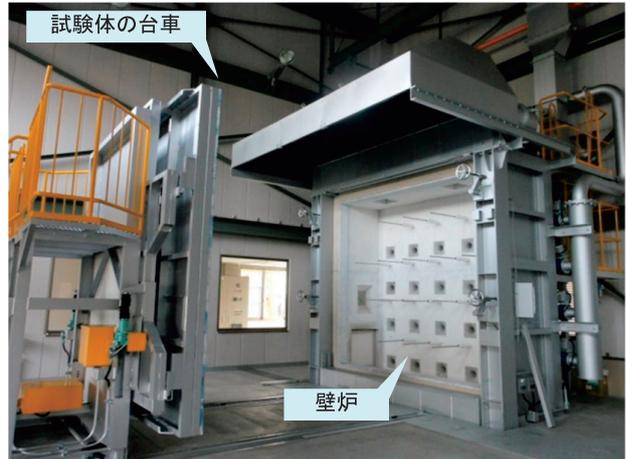
写真-1 壁炉 (壁炉2)
