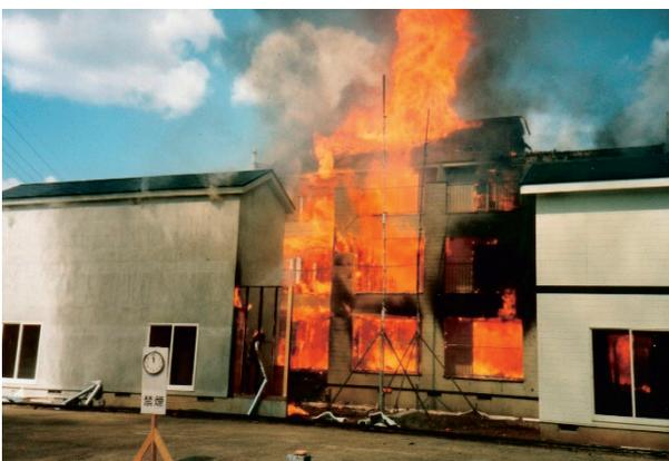
図-5 市街地型木造3階建共同住宅火災実験（1996年）
