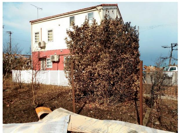
図-6 糸魚川市街地火災（2016） 類焼を免れた防火構造住宅
