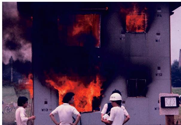
図-4 枠組壁工法住宅火災実験(一般住宅型、1976年)
