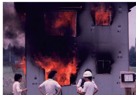
枠組壁工法住宅火災実験(1976年)
