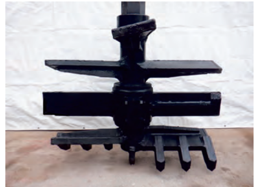
写真-1 掘削攪拌ヘッドの例 (φ1000)
