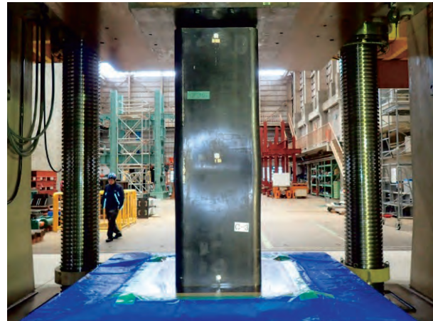
写真-1 JBCR325Pの短柱圧縮試験の様子
