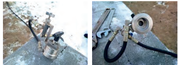
写真-2 加圧注水装置
