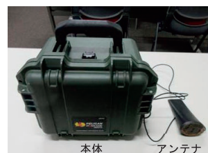
写真-3 データ通信装置
