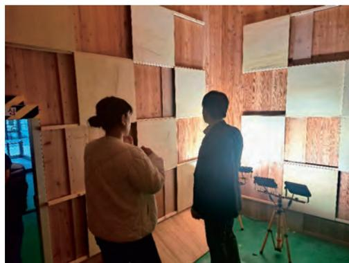
写真-6 同左のCLT箱型試験装置の内部
