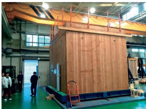
写真-5 遮音実験用のCLT箱型試験装置
