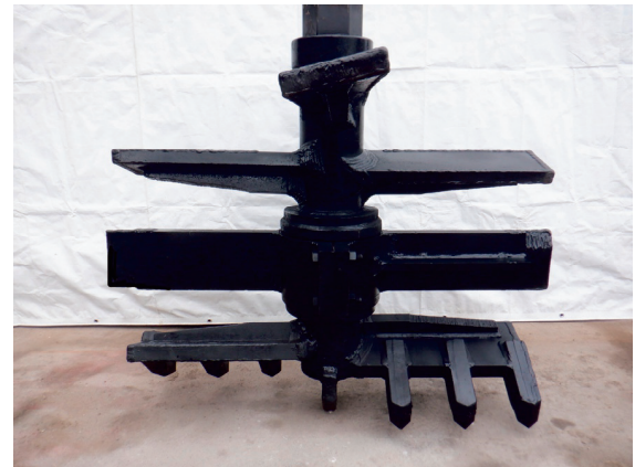
写真-1 掘削攪拌ヘッドの例 (φ1000)
