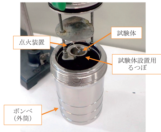
写真-2 燃焼熱試験におけるボンベ内試験体設置状況
