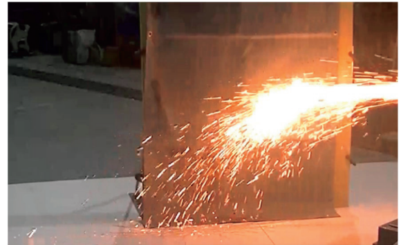
図-8 スパッタシート取付時の様子
