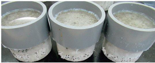
写真-1 スケーリング供試体の状況
