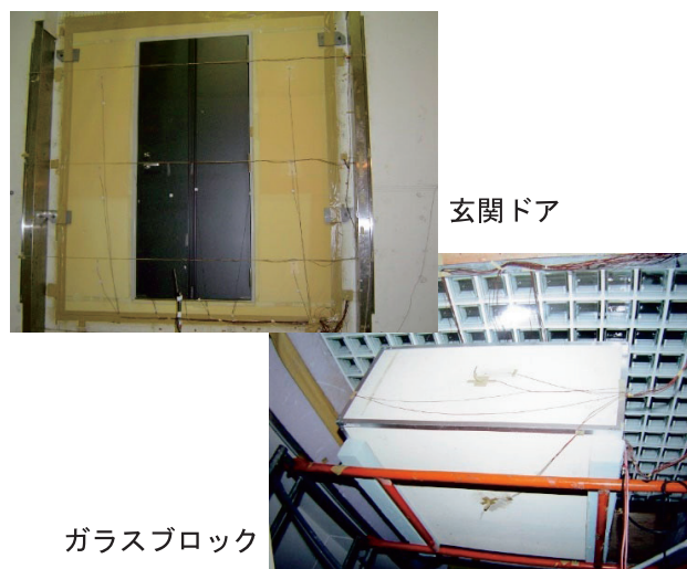
写真-2 熱貫流率試験
