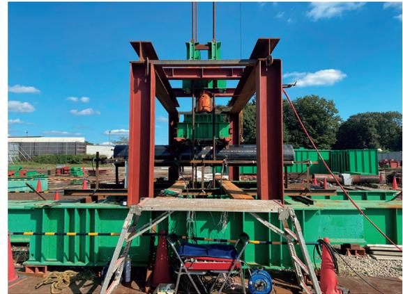
写真-1 4点曲げ試験 試験装置全景
