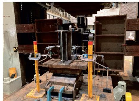
写真-2 520N/mm<sup>2</sup>鋼材及び550N/mm<sup>2</sup>鋼材の3点曲げ試験の状況
