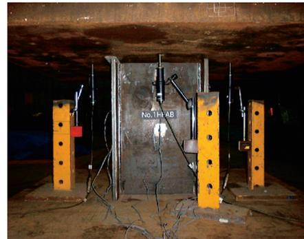
写真-1 520N/mm<sup>2</sup>鋼材及び550N/mm<sup>2</sup>鋼材の短柱圧縮試験の状況
