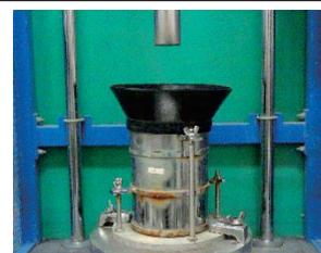
突固めによる土の締固め試験
