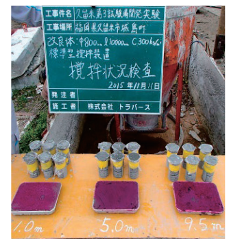
写真-5 攪拌状況検査
