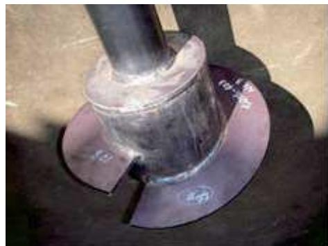
図-1 補強材の先端形状（溶接製）
