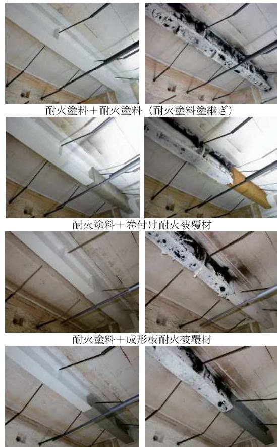
図-1 耐火試験前(左)・後(右)の梁試験体
