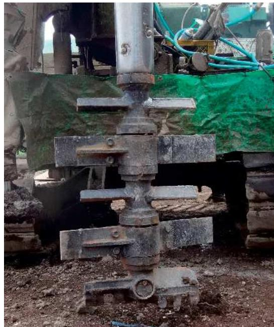
写真-1 掘削攪拌ヘッド
