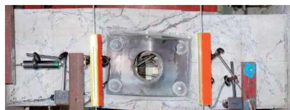
(b) 鋼板補強試験体
