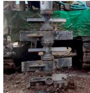
写真-1 挖削ヘッド
