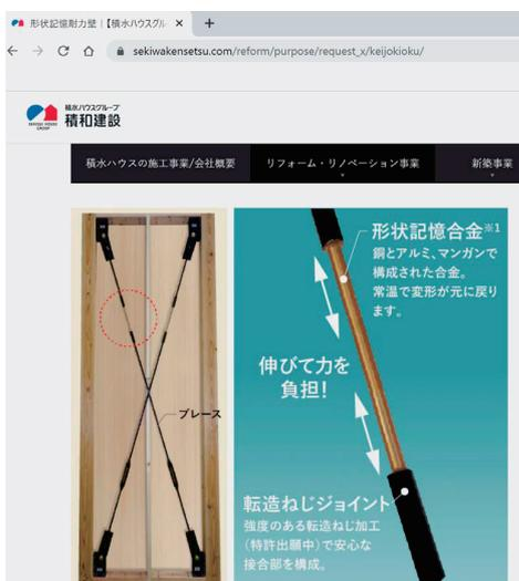
図-15 商品化された木造住宅用耐力壁(左)と超弾性形状記憶合金棒材(右)<sup>9)</sup>
