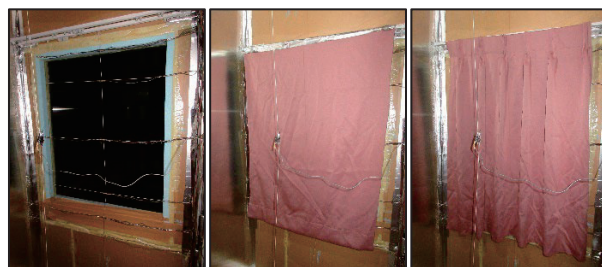
写真-1 実験状況（左：なし、中：フラット、右：2倍ひだ）
