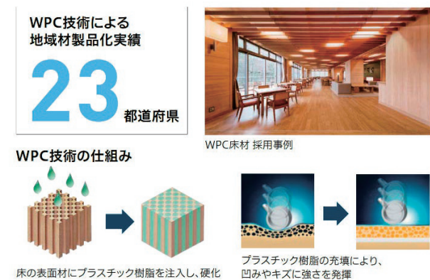
図-4 WPC技術の仕組み
