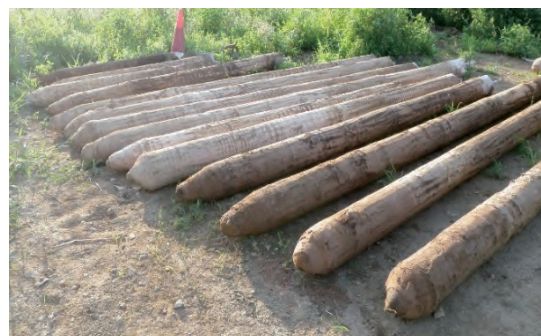
図-1 引き抜いた柱体の状況
