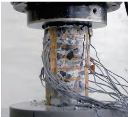
写真-2 圧縮試験時のコア（火害調査事例①）
