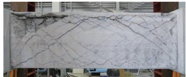
写真-4 公開実験加力終了後の試験体状況
