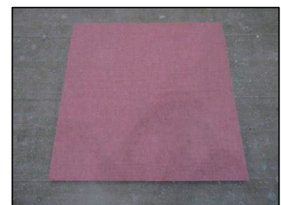
(5) 条件9（タイルカーペット+防音フローリング）
